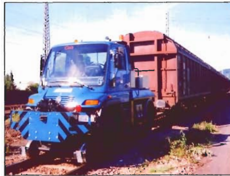
Abb. 10: Vorläuferbetrieb mit dem Unimog (rechts: für das Umsetzen nach dem Gleisrückbau asphaltierte Fläche)
